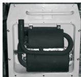
2. Scoateți sistemul de eșapament dual
