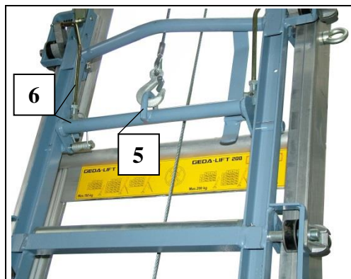
Fig. 38 Atârnarea cablului la sanie
