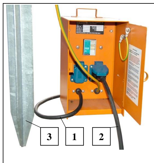
Fig. 17 Distribuitorul curentului electric de șantier
